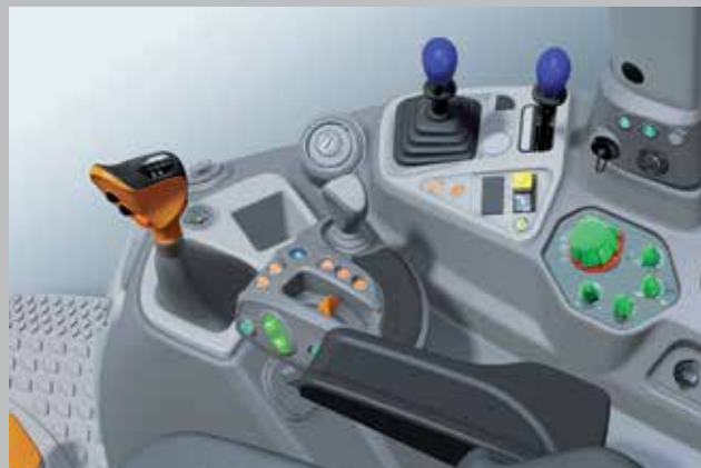
Przekładnia Powershift. Manualna zmiana biegów i półbiegów.
