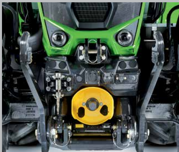
Nowy przedni podnośnik z funkcją sterowania położeniem ma większy udźwąg (tylko modele TTV).
