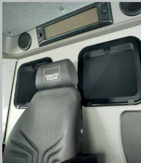
Podwójne okienko kontrolne zbiornika.
