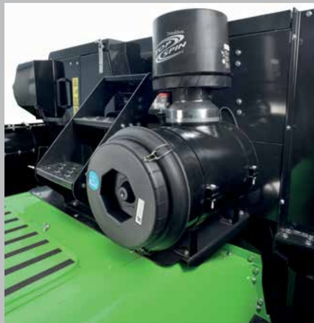
Wysoko-wydajny filtr powietrza z systemem samoczyszczenia.
