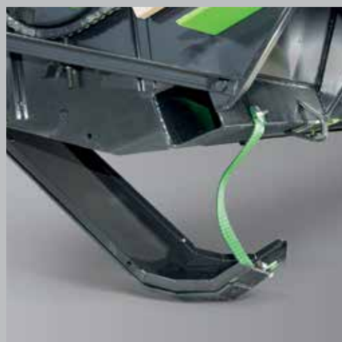
Czujniki systemu Autocontrol pod hedermem.
