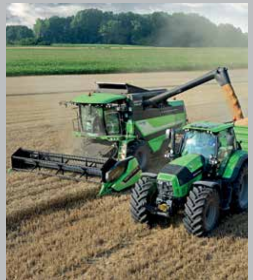
Możliwość rozładunku w każdym położeniu rury wyładawczej.
