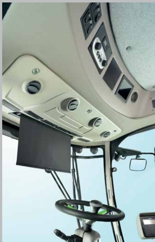
Układ wentylacji i wydajnej klimatyzacji. Składana osłona przeciwsłoneczna.
