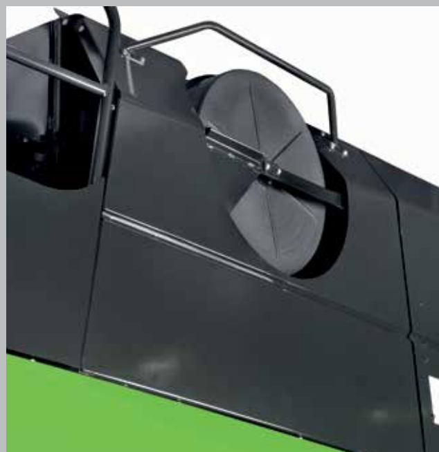
Duży filtr obrotowy gwarantuje wysoką skuteczność działania układu chłodzenia.
