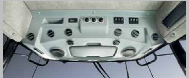
Wydajny system wentylacji oraz klimatyzacji.
